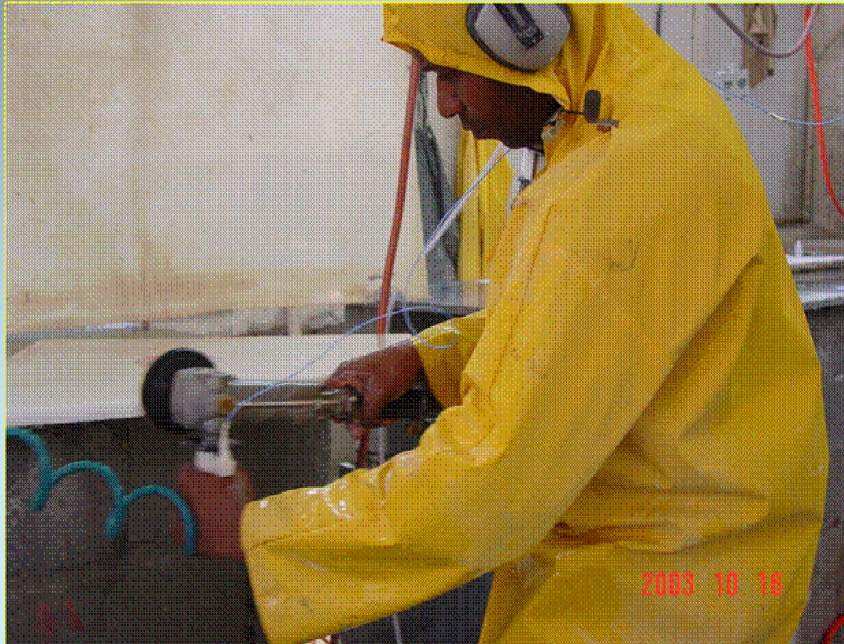
Empresa 15 - Concentração de sílica =  $0,01\text{mg}/\text{m}^3$  (menor que o VR) VR= $0,05\text{ mg}/\text{m}^3$
