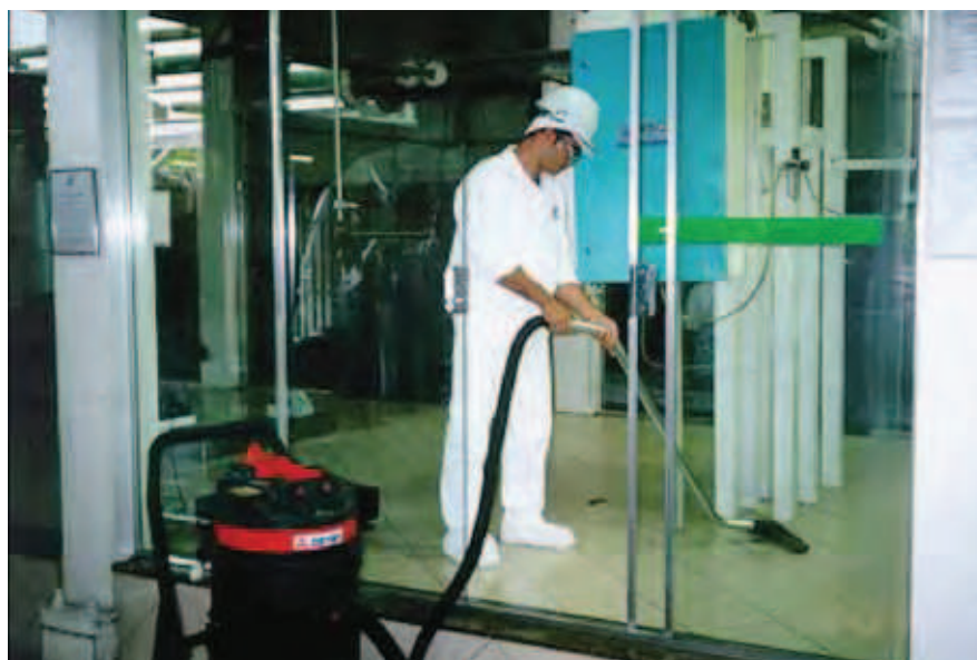
Figura 102 - Aspiração de sujidades do piso da área de enclausuramento (ensaque).
