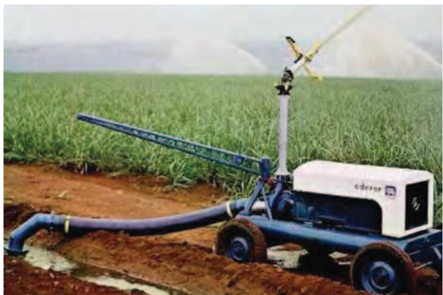
Figura 86 - Aspersor tipo montagem direta succionando de canal.
