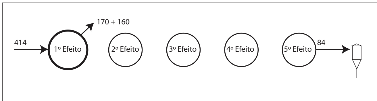
Figura 96 - Diagrama de evaporação de 5º efeito com sangria de vapor vegetal no 1º efeito para cozimento e aquecimento do caldo da fábrica.
