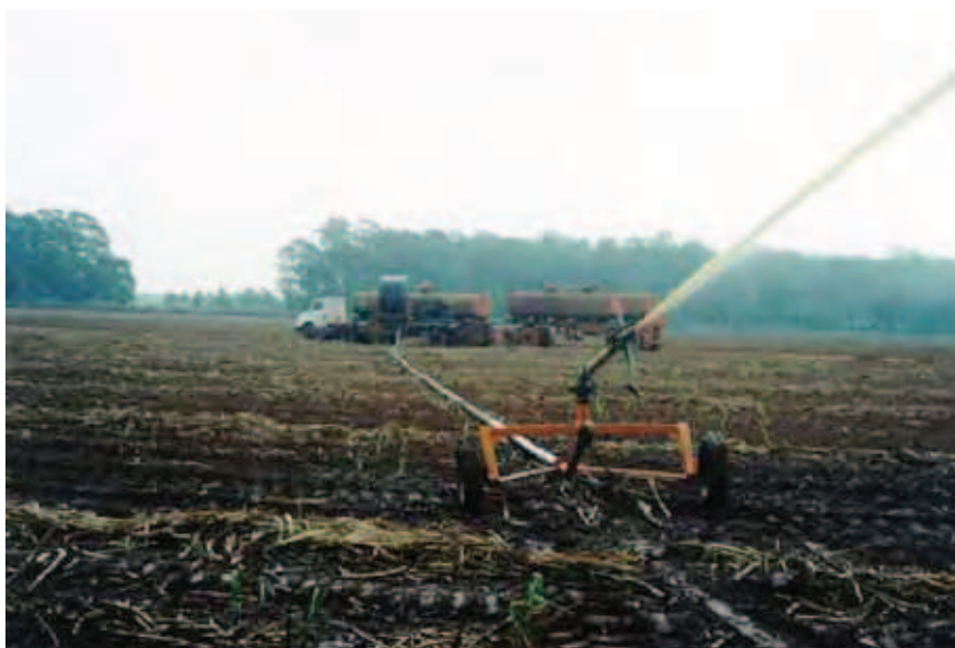
Figura 88 - Aspersão com carretel enrolador acoplado diretamente no caminhão.
