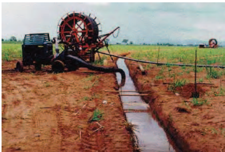
Figura 87 - Carretel enrolador com captação no canal.
