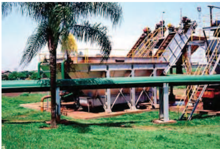
Figura 74 - Decantadores/Flotadores (DFF) modelo CTC instalado em uma usina.
